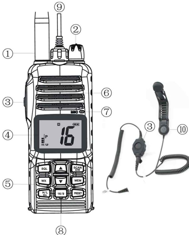
1. - Гнездо для подключения гибкой антенны SMA160.
